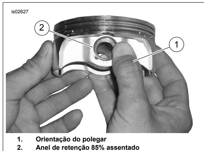
Figura 4. Instalação do anel de retenção
