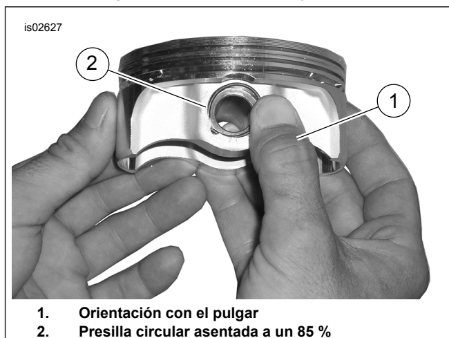
Figura 4. Instalación de la presilla circular
