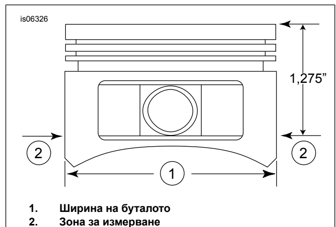
Фигура 2. Мерки на буталото
