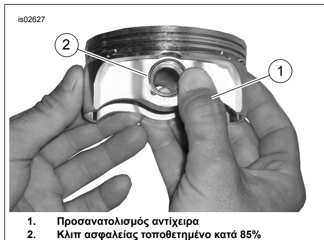
Εικόνα 4. Εγκατάσταση του κλιπ ασφαλείας
