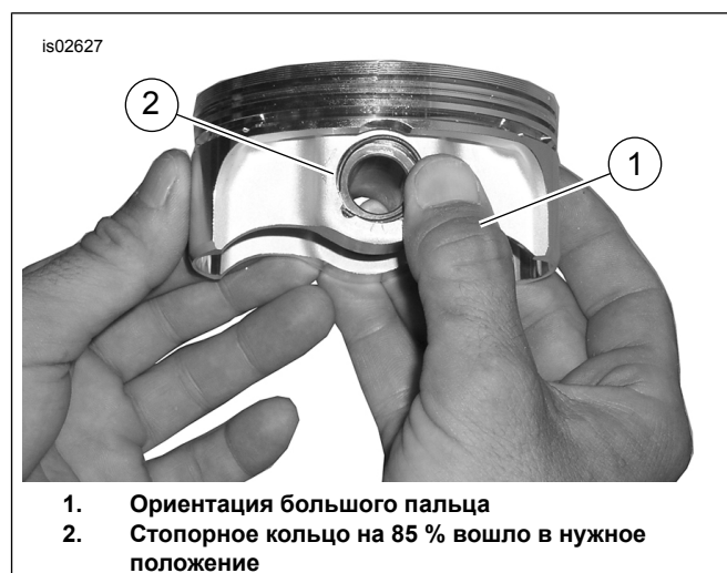
Рисунок 4. Установите стопорное кольцо
