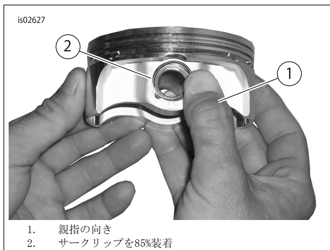
図4。サークリップの取り付け
