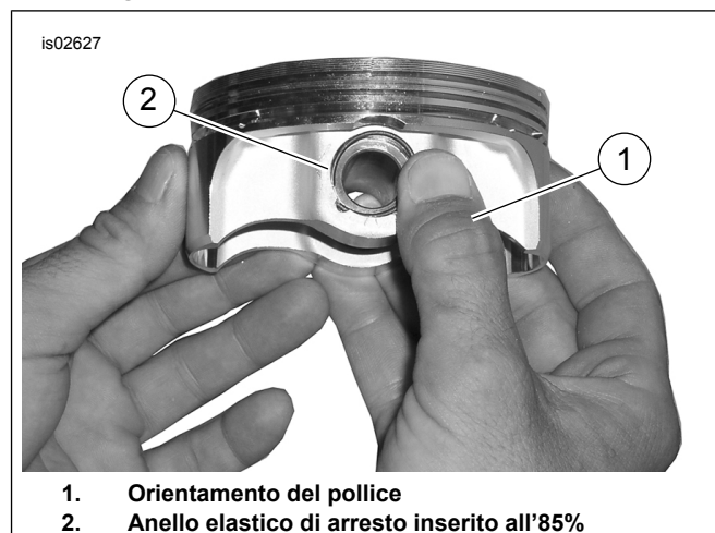
Figura 4. Installazione dell'anello elastico d'arresto
