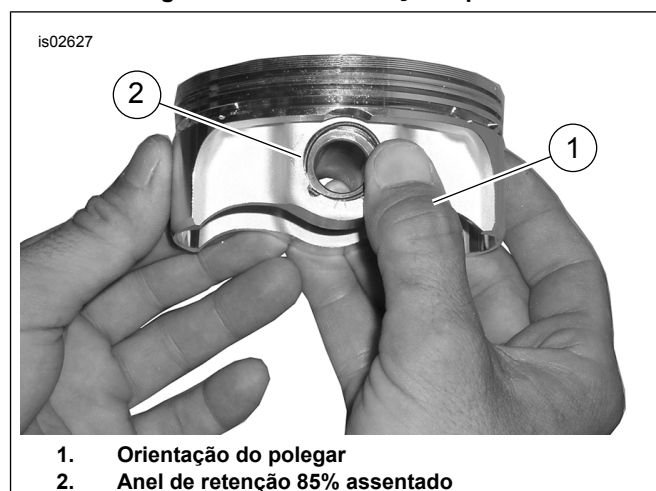
Figura 4. Instalação do anel de retenção
