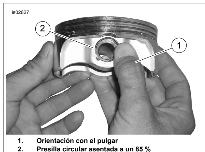
Figura 4. Instalación de la presilla circular
