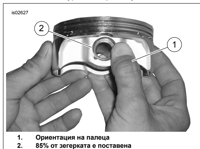
Фигура 4. Монтаж на зегерка
