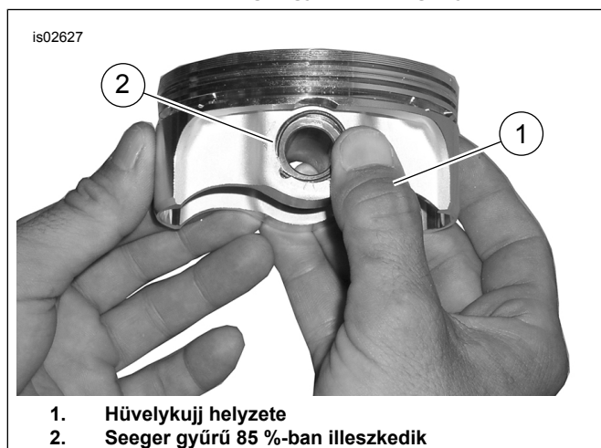
Ábra 4. Seeger gyűrű beszerelése
