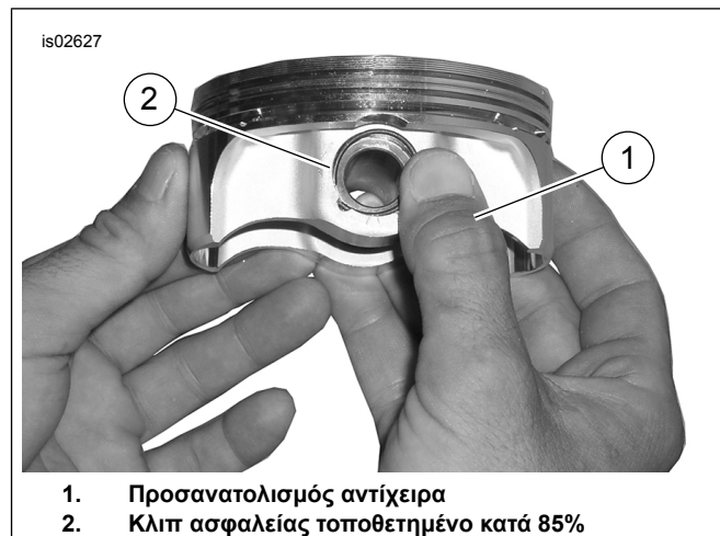
Εικόνα 4. Εγκατάσταση του κλιπ ασφαλείας
