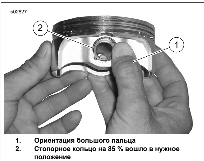
Рисунок 4. Установите стопорное кольцо
