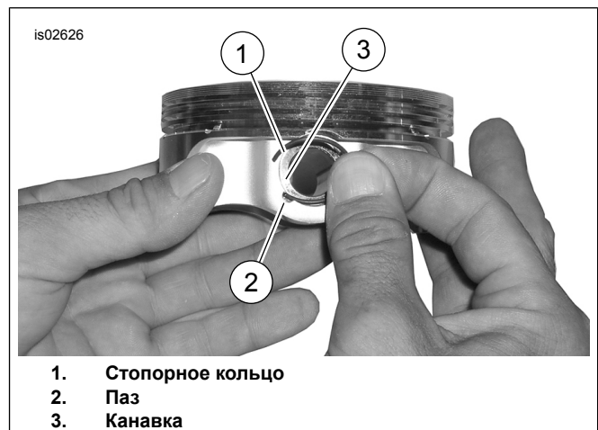
Рисунок 3. Стопорное кольцо и поршень
