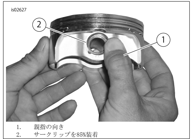
図4.サークリップの取り付け
