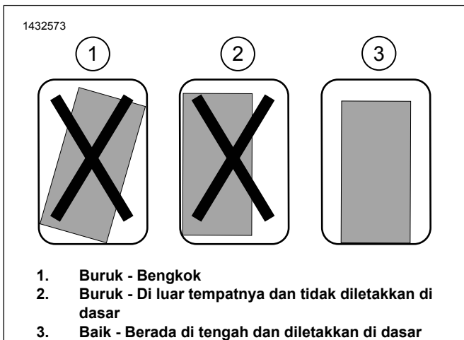
Gambar 11. Pemasangan Braket Dudukan
