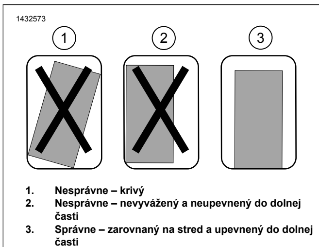
Obrázok 11. Inštalácia montážneho držiaka
