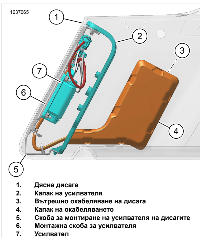
Фигура 13. Окабеляване на дисага с усилвател
