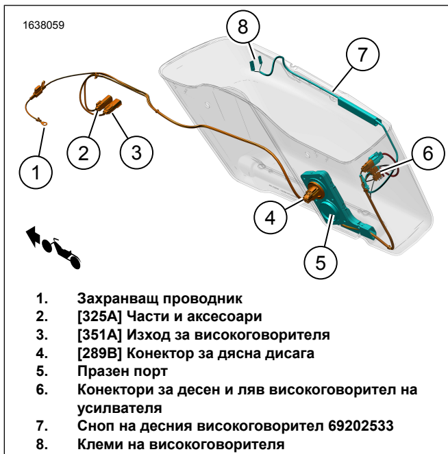
Фигура 5. Прекарване на окабеляване за дясна дисага
