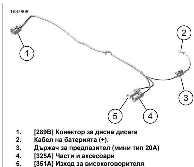
Фигура 15. Външно окабеляване 69202870
