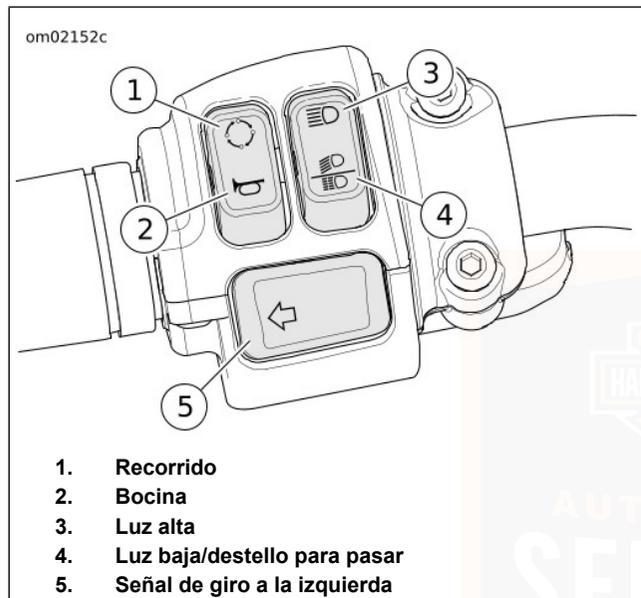
**Figura 4. Módulo de interruptores de la mano izquierda (típico)**
