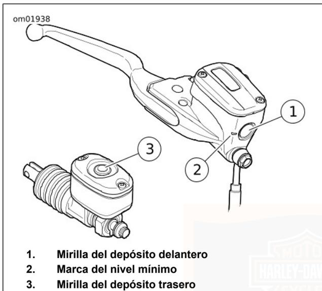
Figura 50. Depósitos de líquido de frenos
