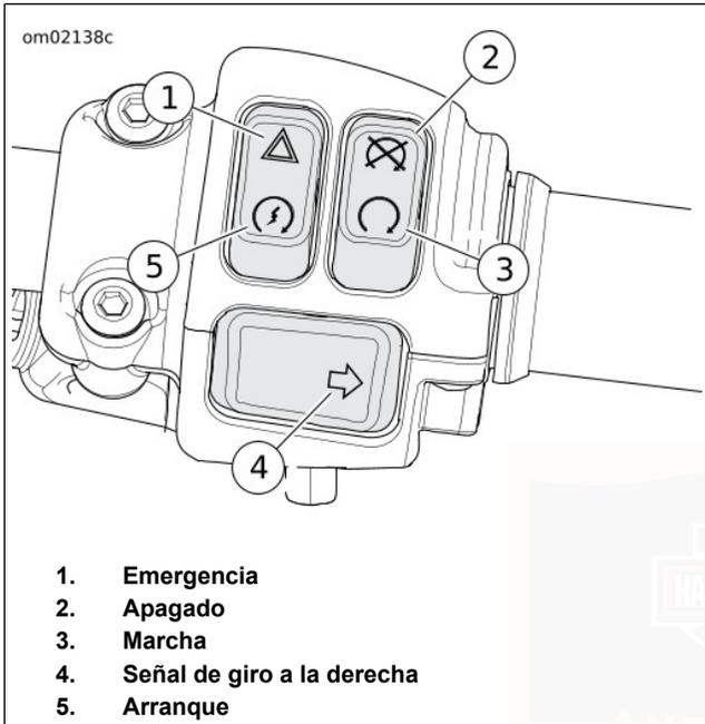
Figura 6. Interruptores de control manual del lado derecho
