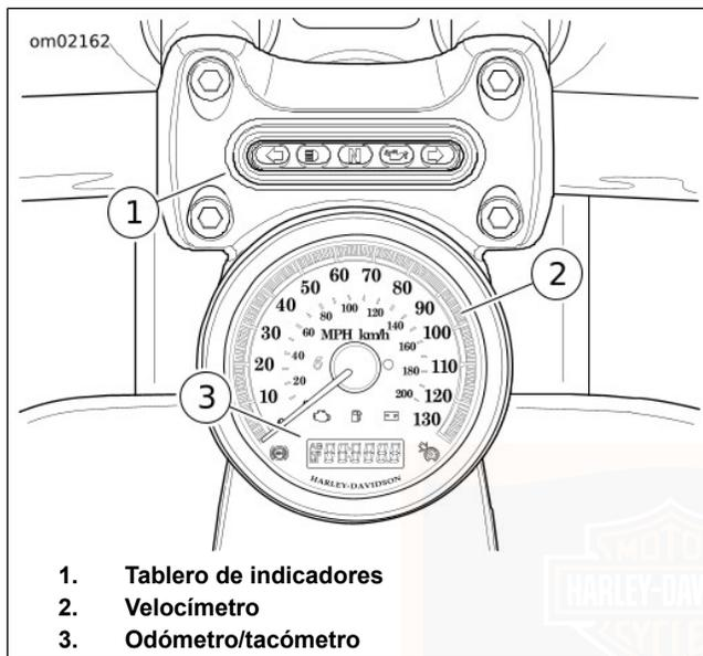
Figura 14. Instrumentos: FXSB
