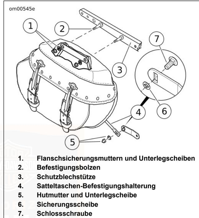
1. Flanschsicherungsmuttern und Unterlegscheiben
