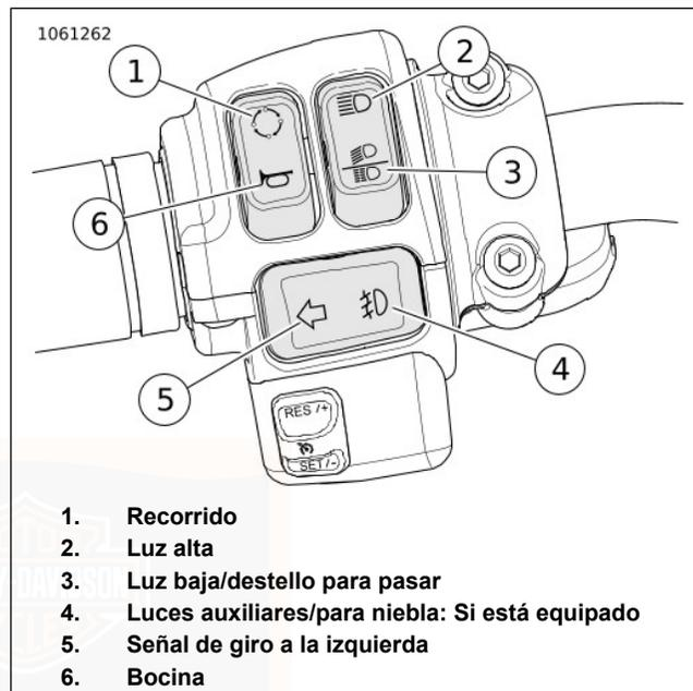
Figura 23. Módulo de interruptores de la mano izquierda (típico)
