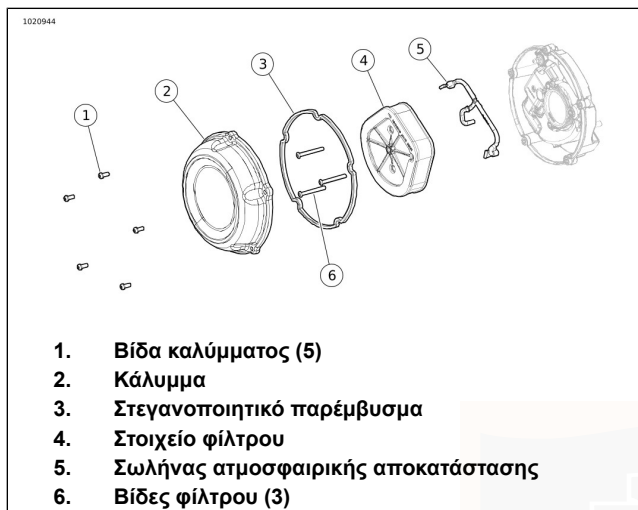
Εικόνα 62. Φίλτρο αέρα: Πέντε βίδες
