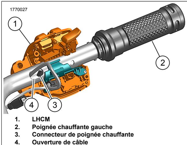
Figure 7. Dépose/pose de la poignée gauche
