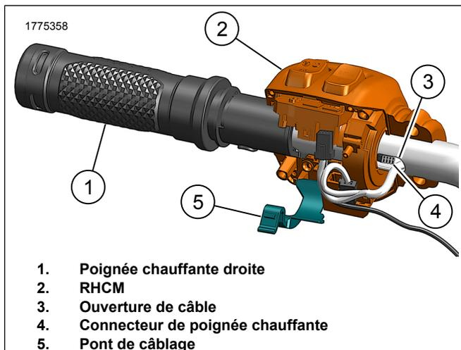
Figure 11. Retrait/installation de la poignée droite
