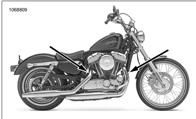
Hình 48. Các vị trí lắp cảm biến oxy (bên trong các ống xả)
