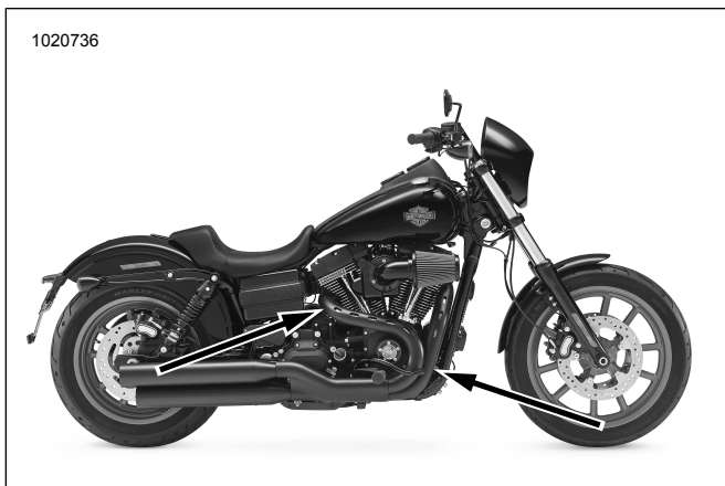
Hình 40. Các vị trí lắp cảm biến ôxy (bên trong các ống xả)
