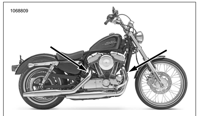
Figura 48. Localizações do sensor de oxigênio (lado interno dos canos de escape)
