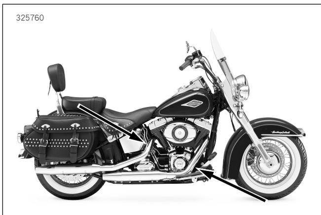
圖33. 氧氣感測器位置（排氣管的內側）
