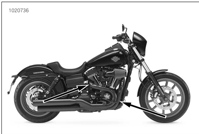
圖40. 氧氣感測器位置(排氣管的內側)
