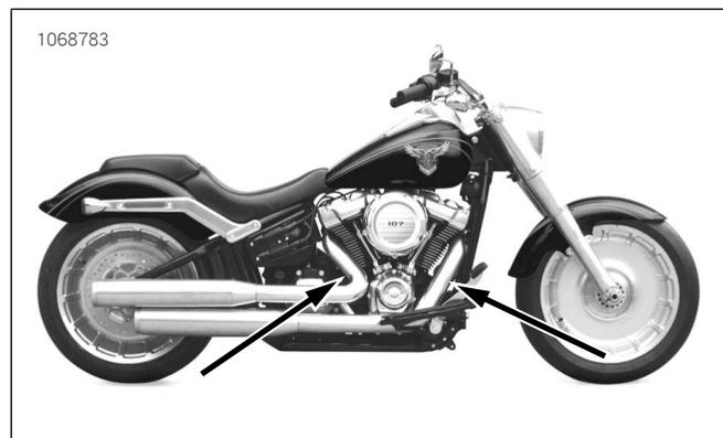
圖22。氧氣感測器位置(排氣管的內側)
