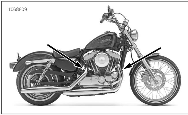
圖48。氧氣感測器位置(排氣管的內側)
