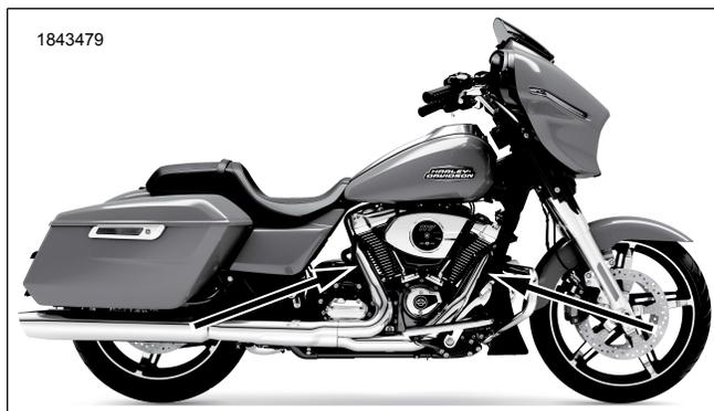
圖2。氧氣感測器位置(排氣管的內側)
