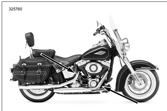
Figura 33. Ubicaciones del sensor de oxígeno (lado interior de los tubos de escape)
