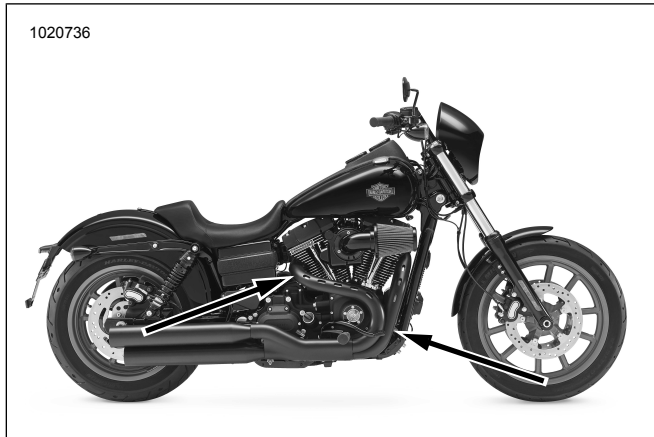
Figura 40. Ubicaciones del sensor de oxígeno (lado interior de los tubos de escape)
