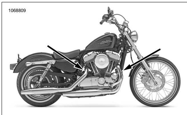
Figura 48. Ubicaciones del sensor de oxígeno (lado interior de los tubos de escape)
