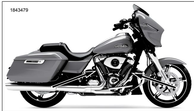
**Figura 2. Posizioni dei sensori dell'ossigeno (lato interno dei tubi di scarico)**
