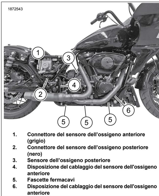
**Figura 8. Disposizione del cablaggio del sensore ATM**
