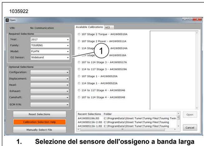
**1. Selezione del sensore dell'ossigeno a banda larga**
