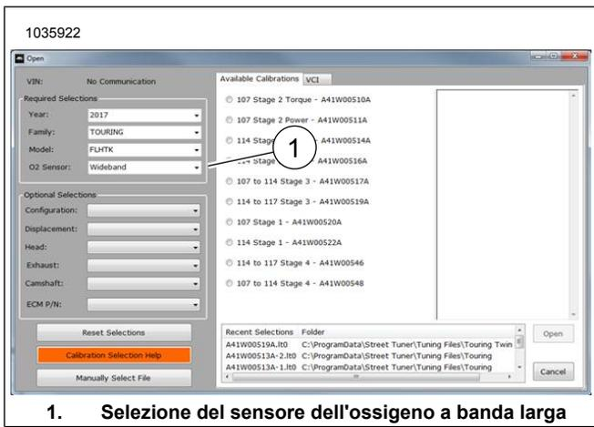
Figura 51. Selezione del sensore dell'ossigeno a banda larga
