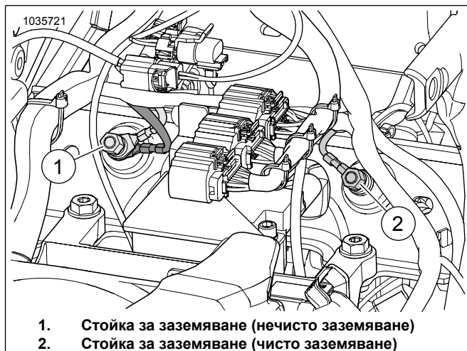
Фигура 15. Местоположения на стойките за заземяване на кутията на акумулатора
