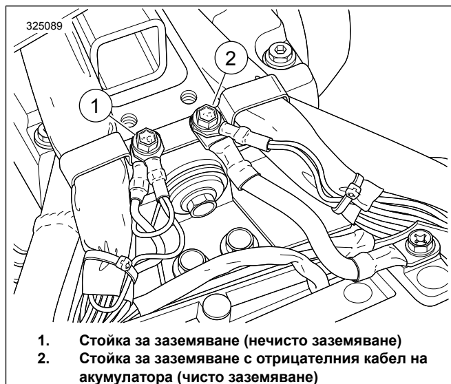
Фигура 34. Местоположения на стойките за заземяване на кутията на акумулатора
