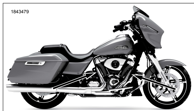
Фигура 2. Местоположения на кислородния сензор (вътрешната страна на тръбите на ауспуха)
