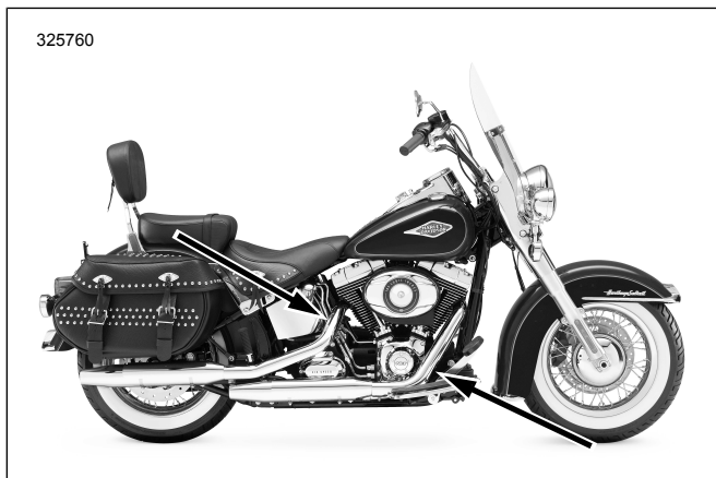
Фигура 33. Местоположения на кислородния сензор (вътрешната страна на тръбите на ауспуха)
