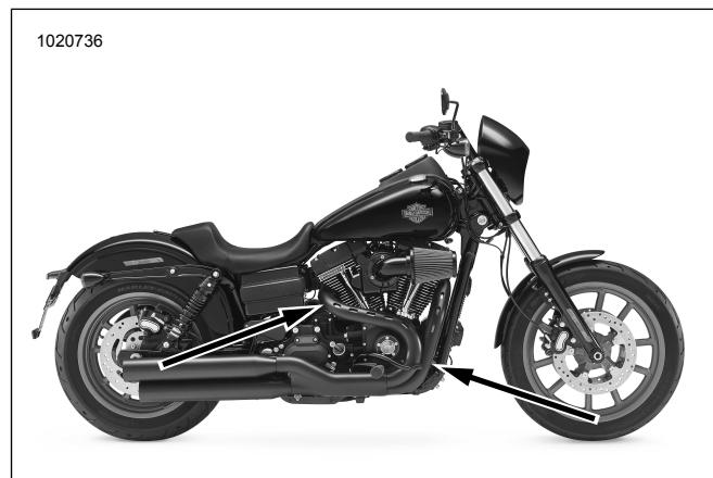
Фигура 40. Местоположения на кислородния сензор (вътрешната страна на тръбите на ауспуха)
