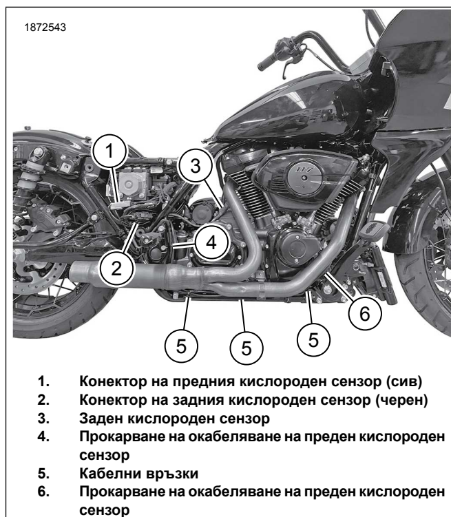
Фигура 8. Прокарване на окабеляване на АТМ сензор
