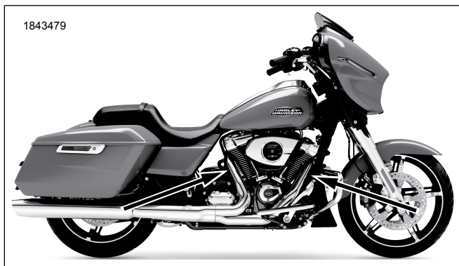
Joonis 2. Lambdaanduri asukohad (väljalasketorude siseküljel)
