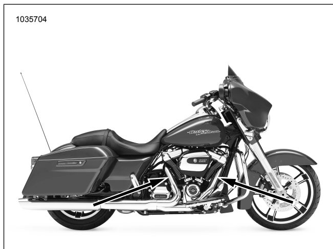
Joonis 11. Lambdaanduri asukohad (väljalasketorude siseküljel)
