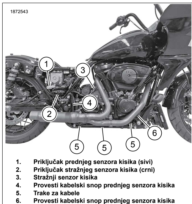
Slika 8. Provođenje kabelskog snopa ATM senzora
