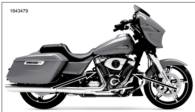
図2。オキシジェンセンサーの位置(エキゾーストパイプの内側)
