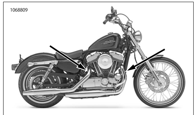
図48。オキシジェンセンサーの位置(エキゾーストパイプの内側)
