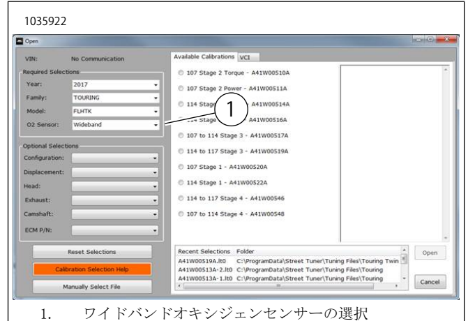
図37. ワイドバンドオキシジェンセンサーの選択
