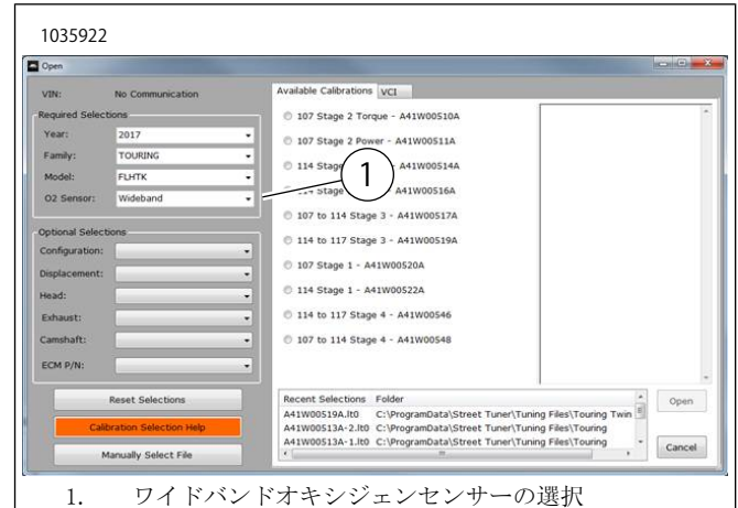
図9. ワイドバンドオキシジェンセンサーの選択
