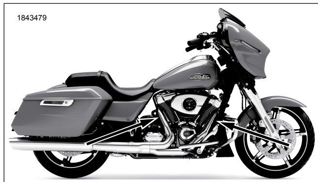
Gambar 2. Lokasi Sensor Oksigen (Sisi Dalam Knalpot)
