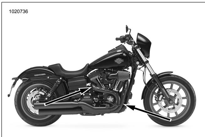
Gambar 40. Lokasi Sensor Oksigen (Sisi Dalam Knalpot)
