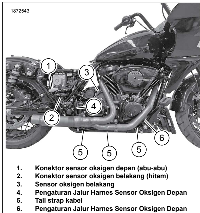
Gambar 8. Pengaturan Jalur Harness Sensor ATM
