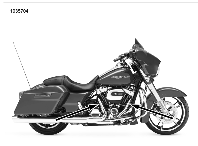
תרשים 11. מיקומי חיישן חמצן (בצד הפנימי של צינורות פליטה)
