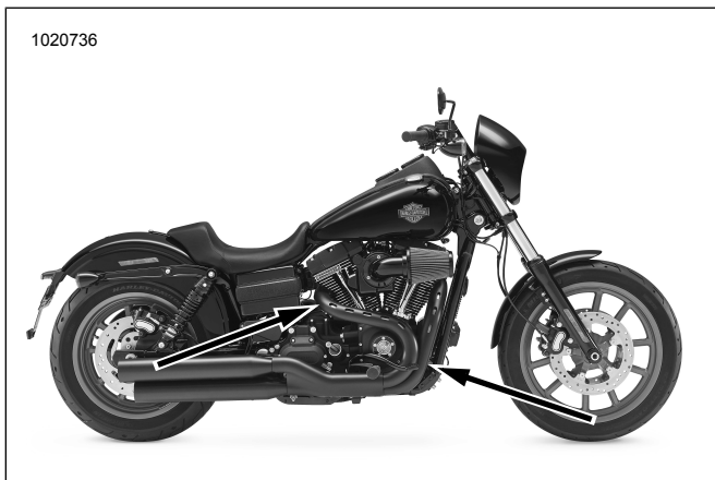
תרשים 40. מיקומי חיישן חמצן (בצד הפנימי של צינורות פליטה)
