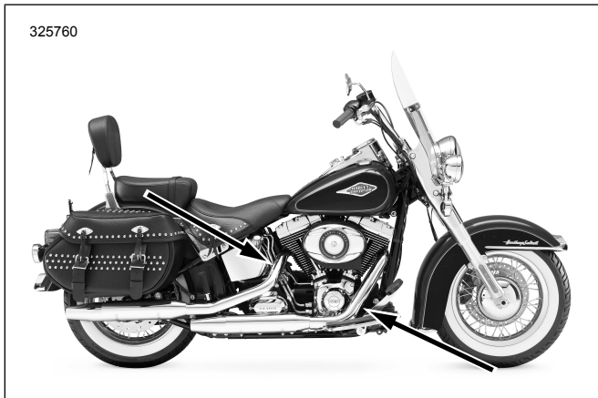
325760 תרשים 33. מיקומי חיישן חמצן (בצד הפנימי של צינורות פליטה)
