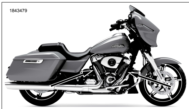
Slika 2. Lokacije senzorja kisika (notranja stran izpušnih cevi)
