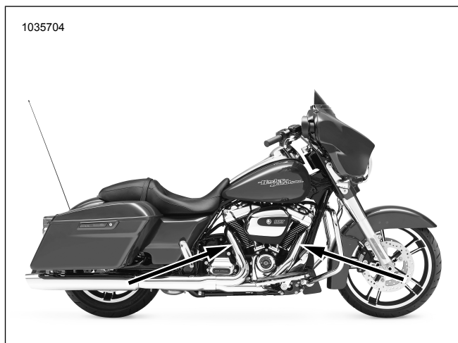
Pav 11. Deguonies jutiklių vietos (vidinė išmetamųjų dujų vamzdžių pusė)
