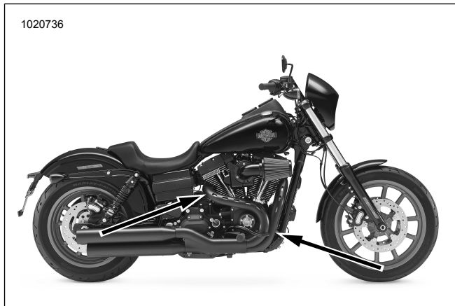
Pav 40. Deguonies jutiklių vietos (vidinė išmetamųjų dujų vamzdžių pusė)
