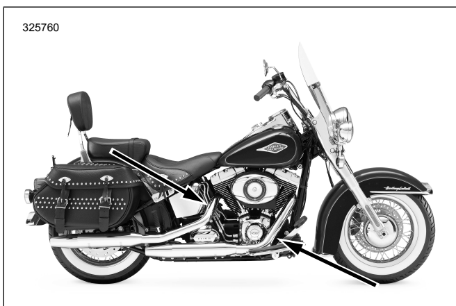
Afbeelding 33. Locaties van de lambdasensor (binnenzijde van uitlaatpijpen)
