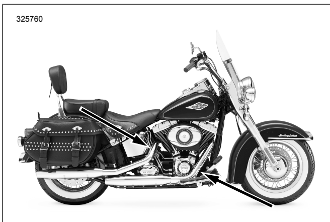
Rysunek 33. Położenie czujników tlenu (wewnętrzna strona rur wydechowych)
