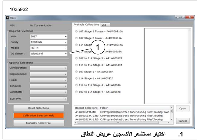
الشكل 37. اختيار مستشعر الأكسجين عريض النطاق
