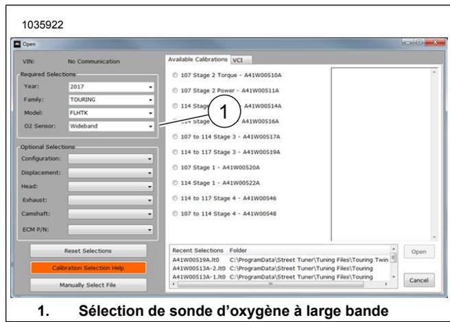
Figure 51. Sélection de sonde d'oxygène à large bande
