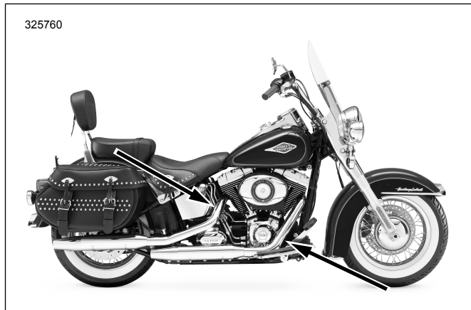
Abbildung 33. Position der Lambdasonde (Innenseite des Auspuffrohrs)
