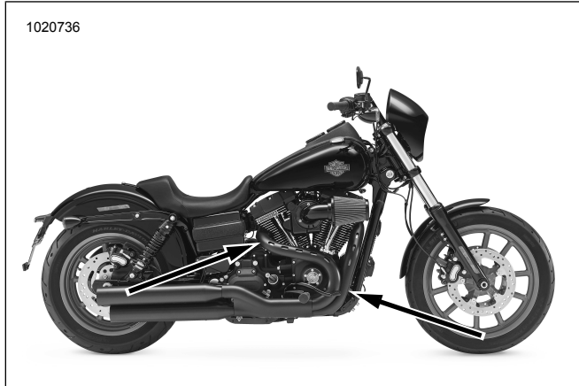
Abbildung 40. Position der Lambdasonde (Innenseite des Auspuffrohrs)
