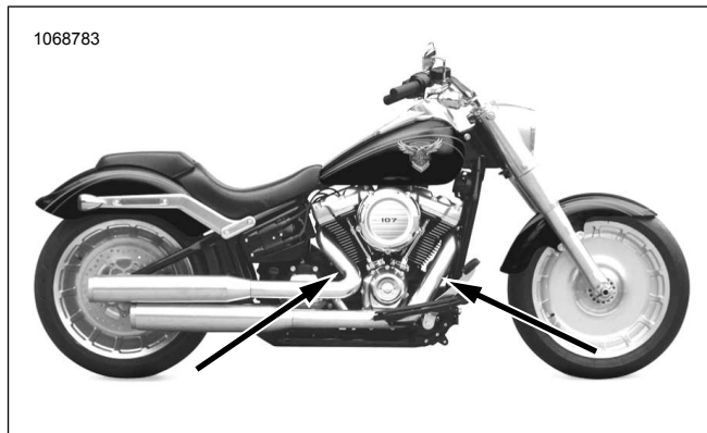
Abbildung 22. Position der Lambdasonde (Innenseite des Auspuffrohrs)
