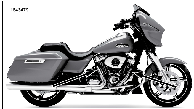
Abbildung 2. Position der Lambdasonde (Innenseite des Auspuffrohrs)
