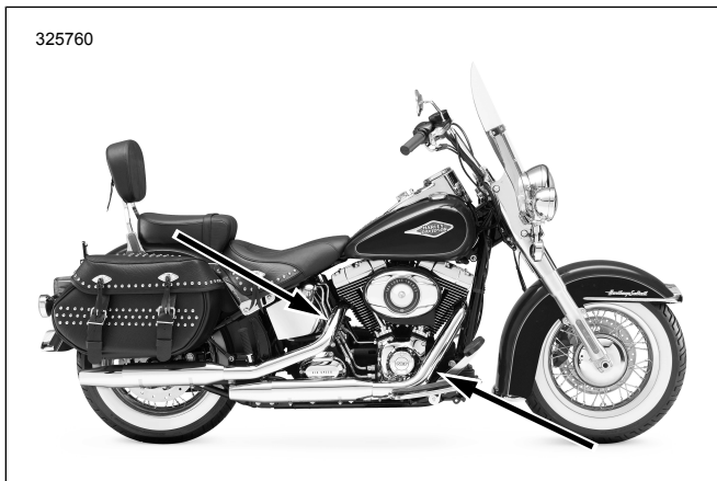
Figur 33. Placeringerne af iltfølere (indvendig side af udstødningsrør)
