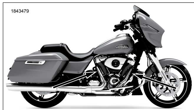
Εικόνα 2. Θέσεις αισθητήρα οξυγόνου (εσωτερική πλευρά σωλήνων εξάτμισης)
