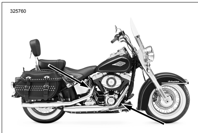
Εικόνα 33. Θέσεις αισθητήρα οξυγόνου (εσωτερική πλευρά σωλήνων εξάτμισης)
