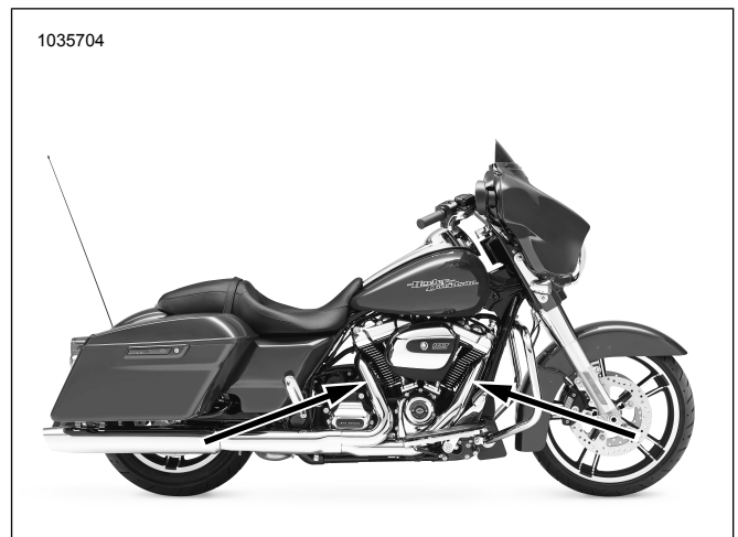
Εικόνα 11. Θέσεις αισθητήρα οξυγόνου (εσωτερική πλευρά σωλήνων εξάτμισης)
