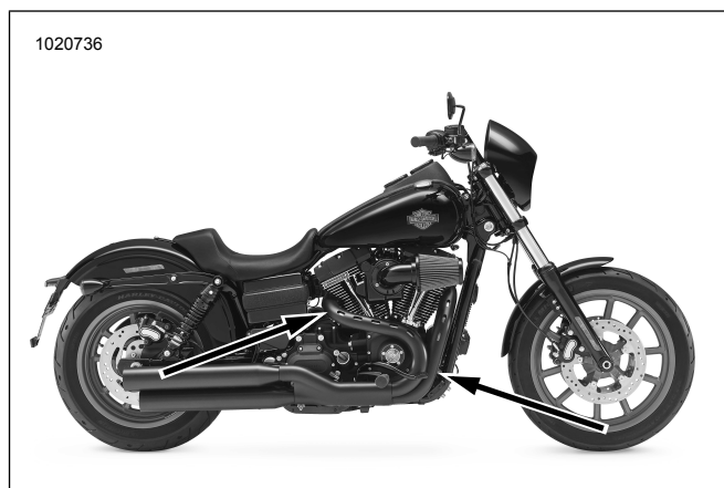
Εικόνα 40. Θέσεις αισθητήρα οξυγόνου (εσωτερική πλευρά σωλήνων εξάτμισης)
