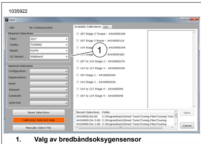
Figur 45. Valg av bredbåndsoxygen sensor
