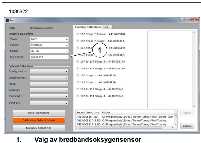
Figur 26. Valg av bredbåndsoksygensensor
