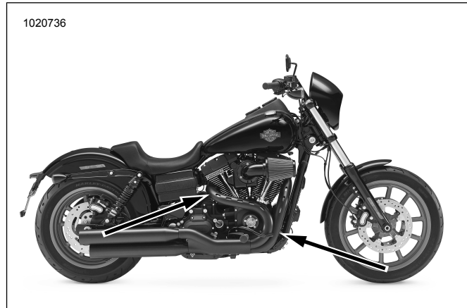
Kuva 40. Happitunnistimien sijainnit (pakoputkien sisäpuolelta)
