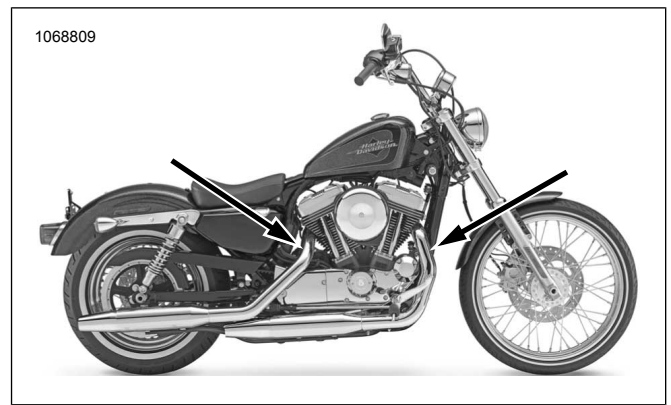
Kuva 48. Happitunnistimien sijainnit (pakoputkien sisäpuoli)
