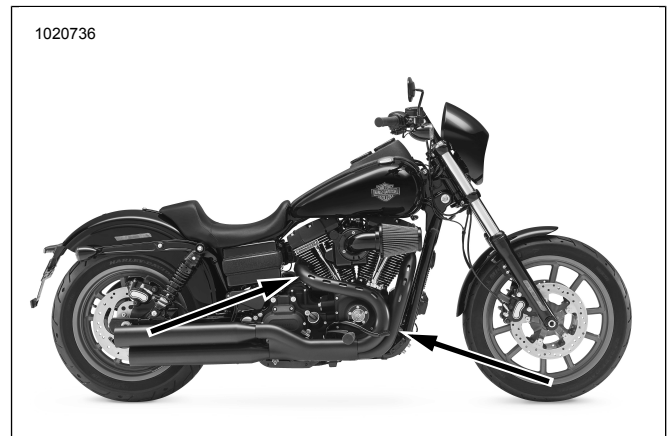
รูปภาพ 40 ตำแหน่งเซ็นเซอร์วัดออกซิเจน (ภายในเครื่องของท่อไอเสีย)
