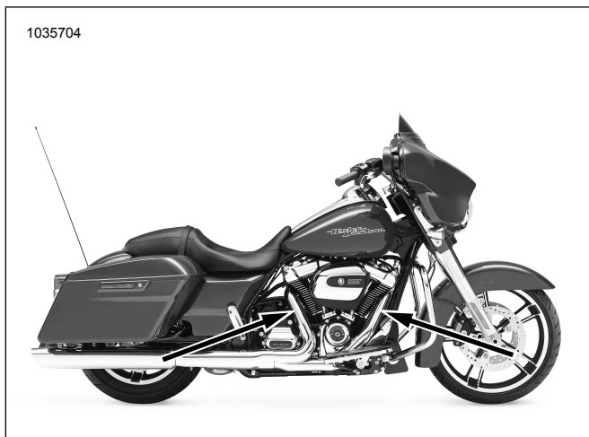
Ábra 11. A lambdaszondák elhelyezkedése (a kipufogócső belső felén)
