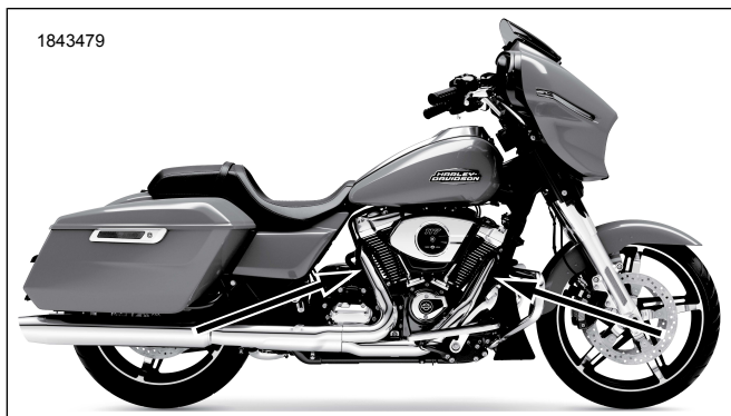
Ábra 2. A lambdaszondák elhelyezkedése (a kipufogócső belső felén)
