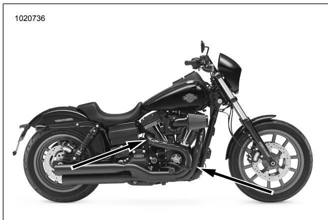
Ábra 40. A lambdaszondák elhelyezkedése (a kipufogócső belső felén)
