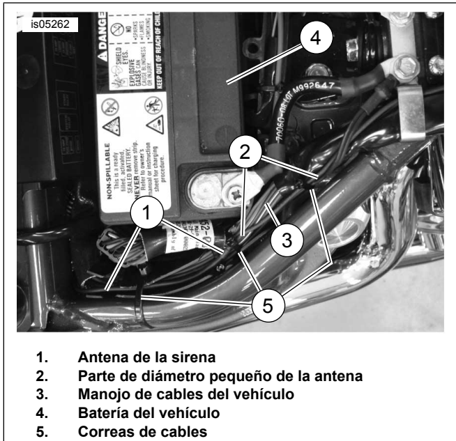
Figura 30. Montaje de la antena de la sirena (FXCW y FXCWC)
