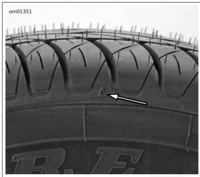
Figure 59. Barre indicatrice d'usure de la bande de roulement du pneu arrière
