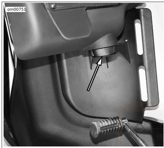
Figure 21. Contrôle de lames d'aérateur de carénage
