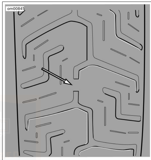
Figure 58. Aspect de la barre d'usure (typique)
