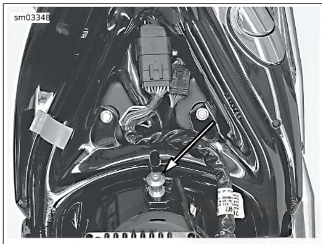
Figure 71. Montant de selle : modèles Sportster XL POSE DE LA SELLE : MODÈLES XL
