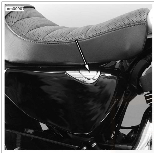
Figure 29. Emplacement de la jauge d'huile : modèles Sportster (modèle XL illustré)
