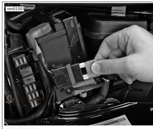
Figure 69. Fusible principal : modèles Sportster (modèle XL illustré)
