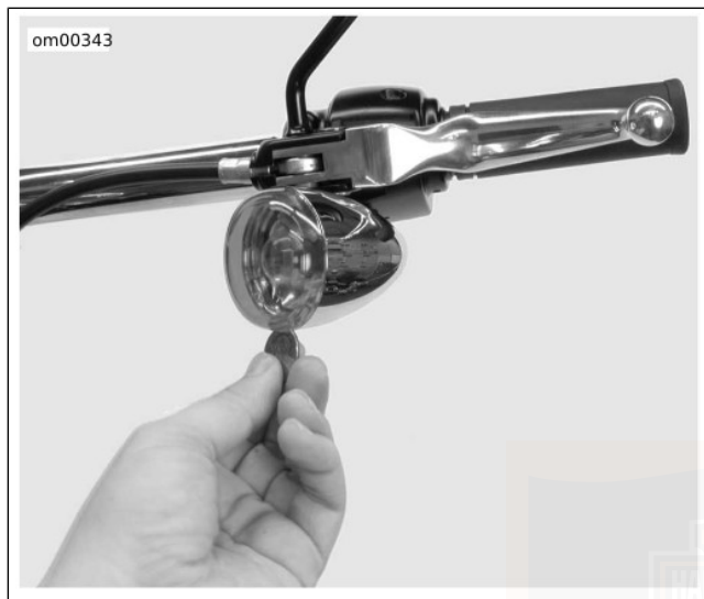
Figure 55. Encoche du capuchon de diffuseur REPLACEMENT D'AMPOULE DE FEU ARRIÈRE : STYLE STANDARD
