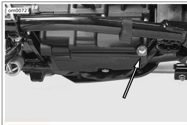
Figur 25. Avtappningsplugg för motorolja (oljetråget under växellådan; vy från fordonets vänstra sida)
